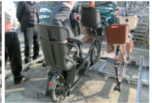
サイズや操作力などをチェック。図面ではわからない操作性などを厳しくチェックする
