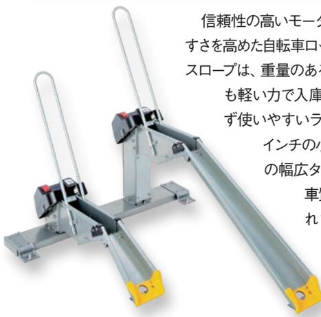
信頼性の高いモーターロック機構に使いやすさを高めた自転車ロック装置です。緩やかなスロープは、重量のある電動アシスト自転車でも軽い力で入庫でき、年齢や性別問わず使いやすいラックとなっています。16インチの小径タイヤ、63mmまでの幅広タイヤ、35kgまでの自転車質量に対応する事で、これまで駐輪できなかったユーザーをしっかりと取り込むことが出来ます。
